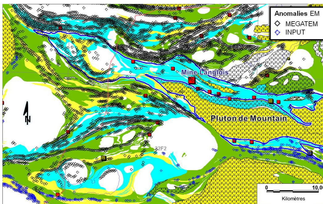
Figure 12. Carte des affinités volcaniques et des anomalies électromagnétiques Megatem et Input de la région de la mine Langlois.
